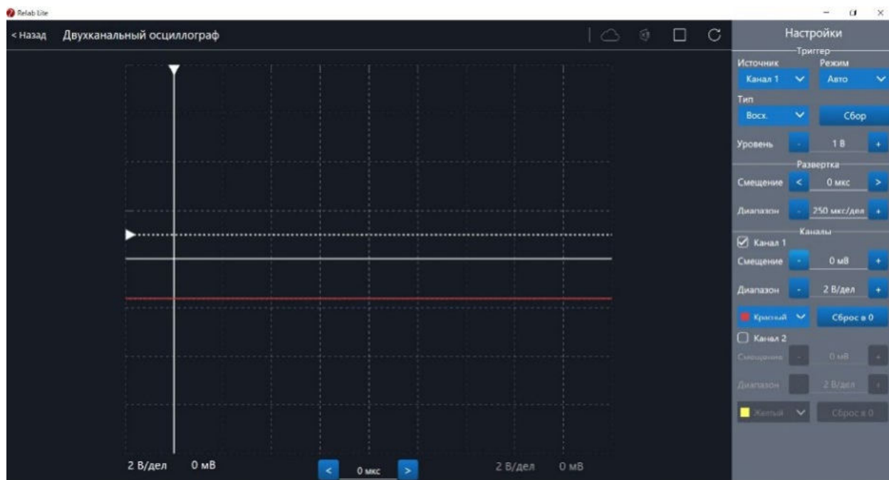
Рис. 40. Сигнал с ненулевым смещением
