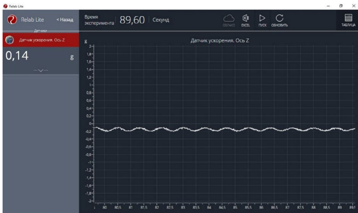
Рис. 3. График гармонических колебаний пружинного маятника
