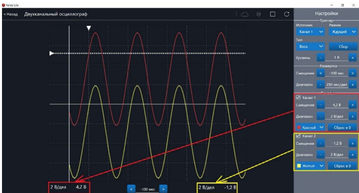
Рис. 39. Использование блока Каналы
